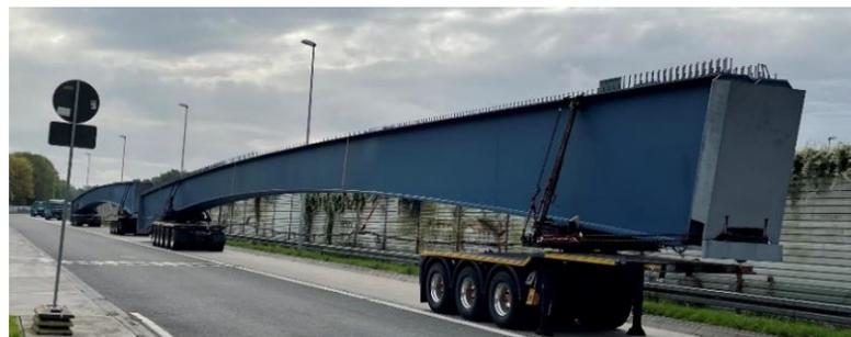
Schwertransport: 167,7 Tonnen schwer, 67 Meter lang, 4,5 Meter hoch und 3 Meter breit.
