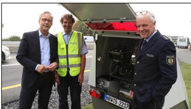
Ohne Personaleinsatz kann der Blitzanhänger mindestens fünf Tage selbstständig die Geschwindigkeit kontrollieren. Das mobile Geschwindigkeitsmessgerät besitzt eine eigene Stromversorgung und ist durch die besondere Verkleidung vor Vandalismus geschützt.
