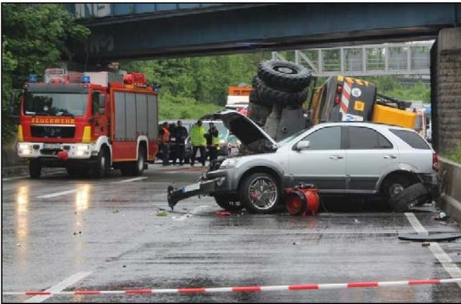
Grund für die Verselbständigung des Baggers war der nicht ganz eingefahrene Knickarm, welcher mit einem Brückenbauwerk zusammenstieß. Deshalb stellte sich der Bagger auf, kippte nach links von der Ladefläche und fiel auf einen Pkw.
