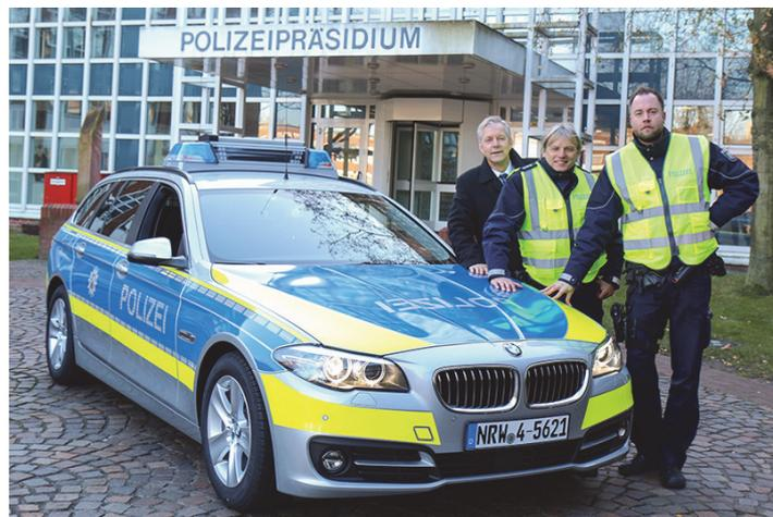
reszierende gelbe Folie an den Fahrzeugseiten erhöht auch bei Tageslicht die Sichtbarkeit. Die sogenannte „Runflat“-Bereifung mit verstärkten Flanken sorgt dafür, dass die Reifen auch bei Luftverlust ihre Form nahezu beibehalten können. In den nächsten Jahren sollen die neuen BMW-Modelle den Fuhrpark der Polizei Dortmund modernisieren. Insgesamt ersetzen die BMW-Modelle nun nach und nach den VW-Passat.
